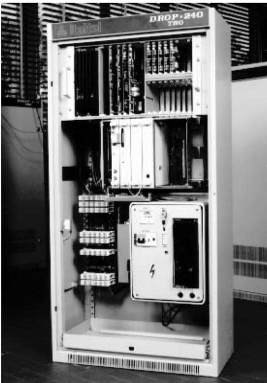
Figura 5 Apparato di Terminazione di Rete Ottica
